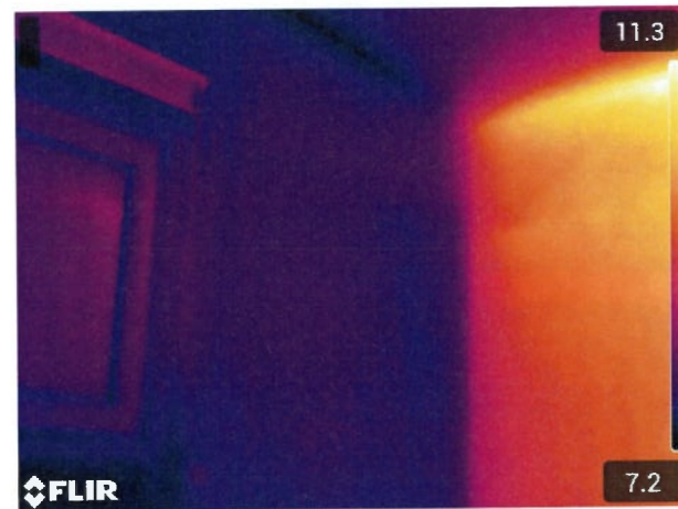
Ce second défaut est visible thermiquement (en bleu foncé).
